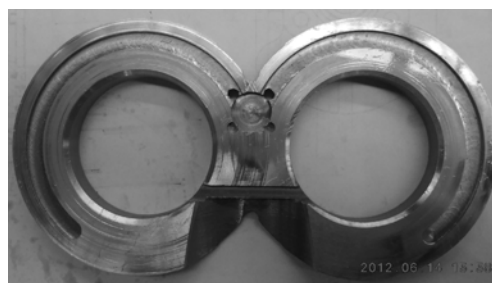
图 2 浮动侧板卸荷槽结构图
