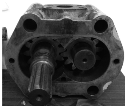
图 1 高压齿轮泵结构图
